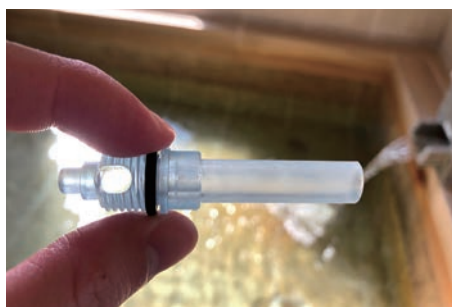
注入点の清掃後
