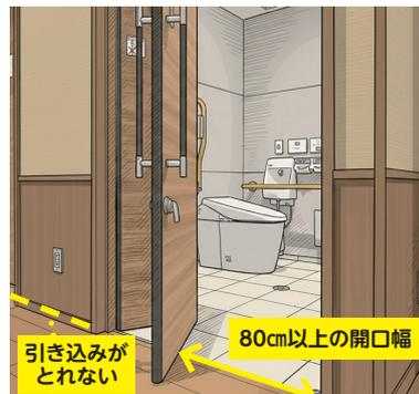
引き戸だと引き込みがとれず、開口幅が80cm以上確保できない場合には、折れ戸を選定することで開口幅が確保できます。
