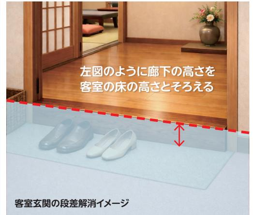
客室内には構造上、どうしても段差が残る場合があります。客室内で段差を解消することが難しい場合でも、廊下側にスロープを設け、手前で高さを調整することで、客室内をフラットにする対応が可能です。
